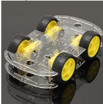
Fig. 5. Șasiul utilizat pentru construcția mașinii.
